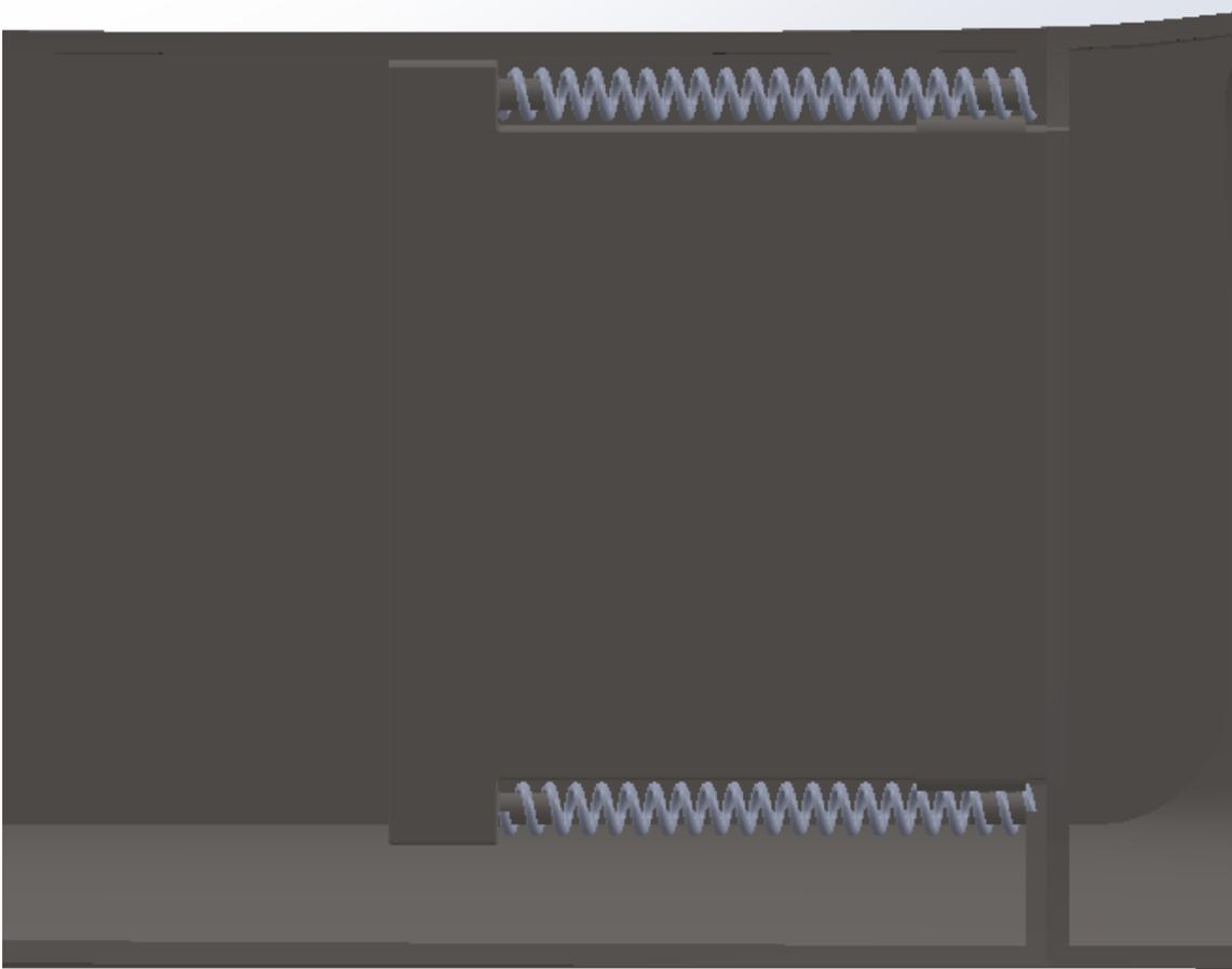
*Figura 48. Detalle muelles de compresión extendidos.*
