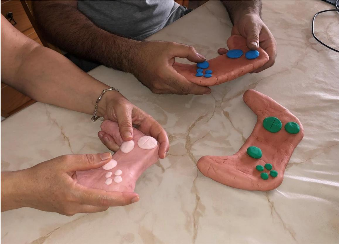
*Figura 19. Prueba de las localizaciones de los botones y forma de los modelos de arcilla.*
