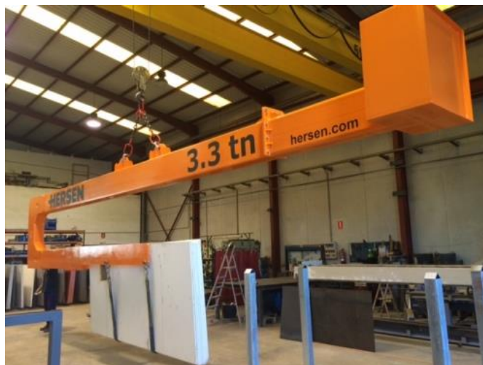
Figura 15. Brazo de carga de la empresa Hersen.
