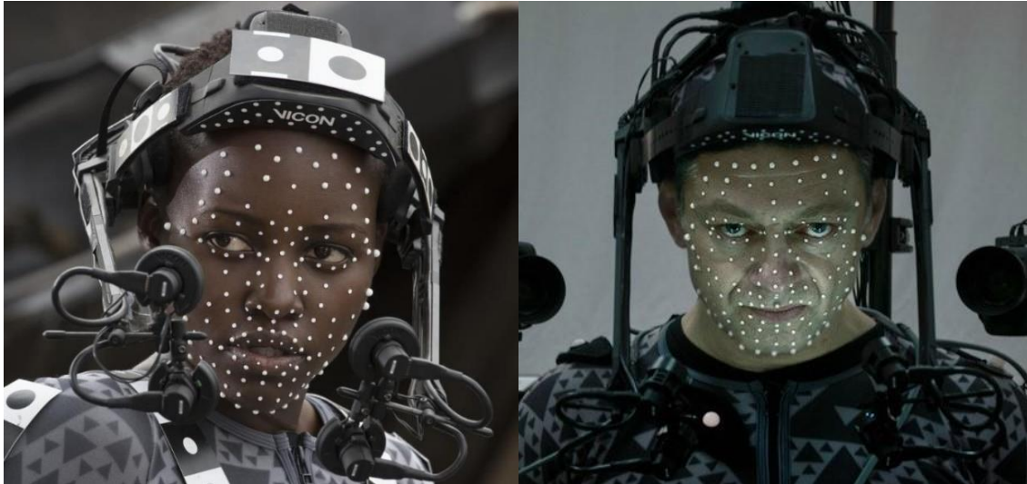
Fig. 17. Exemples de captura dels moviments facials amb marcadors passius
