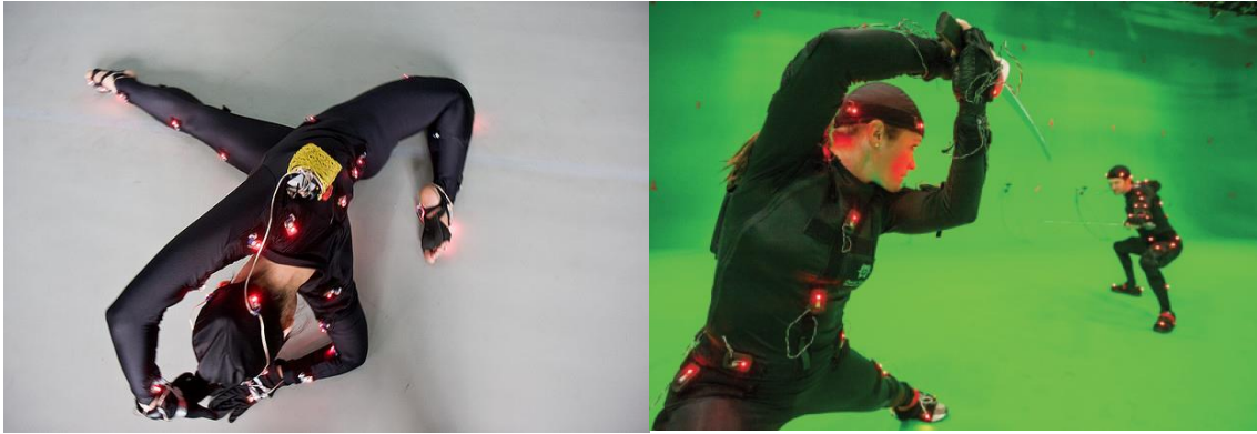
Fig. 18. Exemples de sistemes de MOCAP amb marcadors actius
