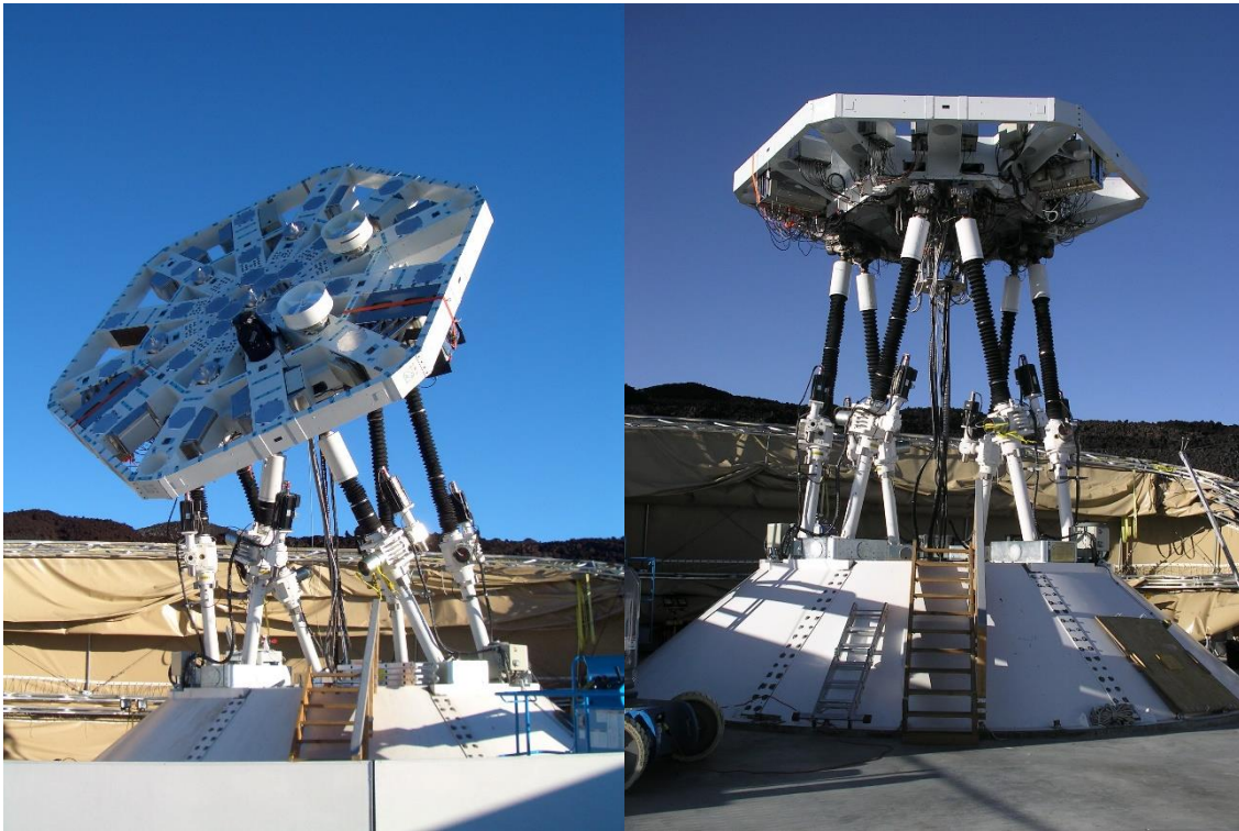
Fig. 6. El robot paral·lel hexàpode AMiBA en el volcà Mauna Loa de Hawaii
