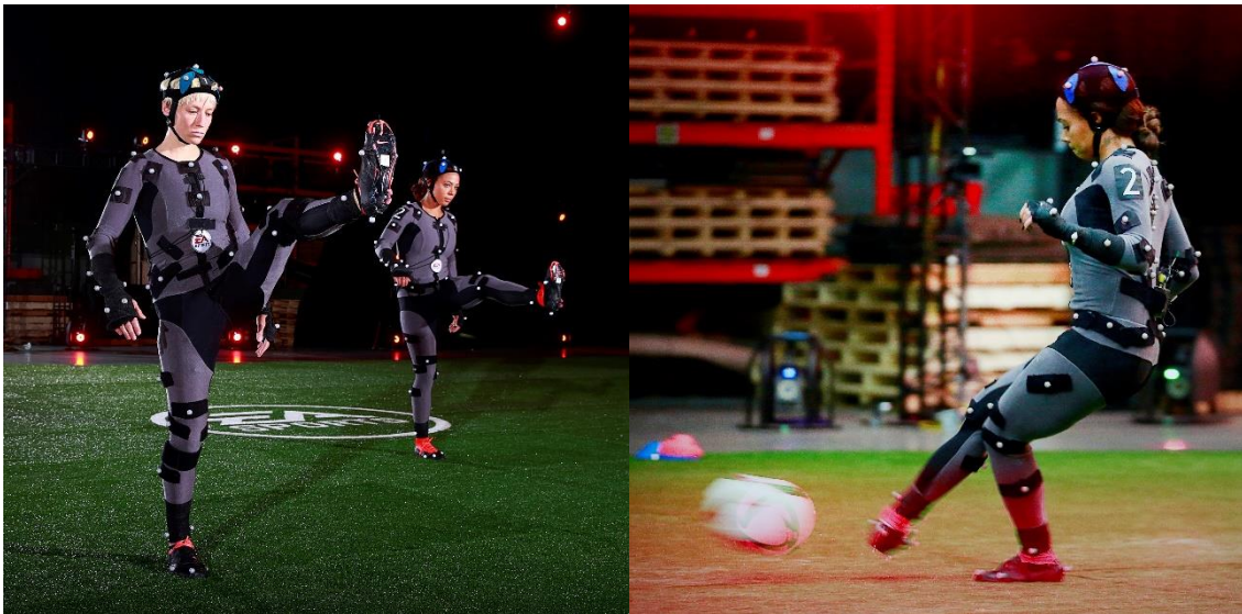
Fig. 19. Exemple d'un sistema de MOCAP amb marcadors passius
