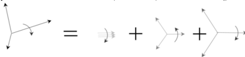
Figura 4.1 Descomposición de un sistema de tensiones simples equilibrado en sus componentes simétricas
