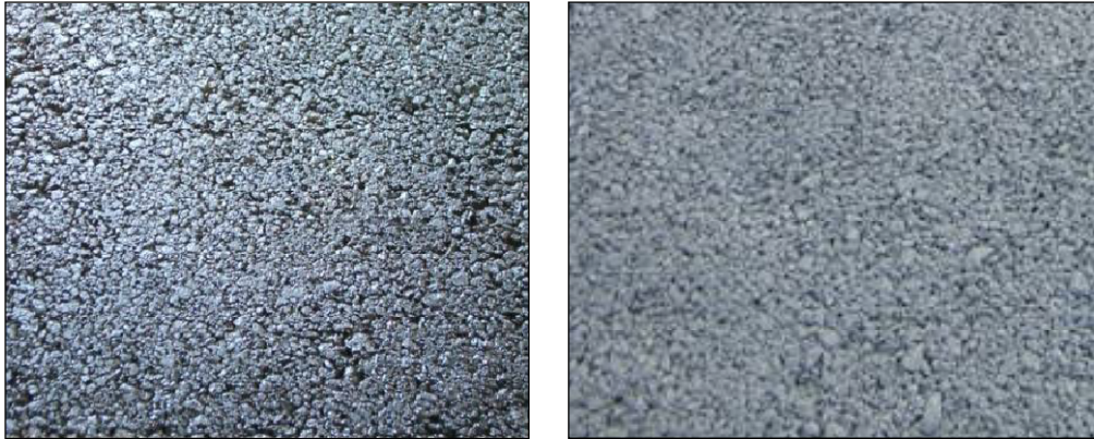
Figura II. 4. Mezcla bituminosa porosa (izquierda) y hormigón poroso (derecha). (Rodríguez Hernández, 2008).
