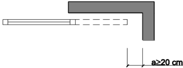
Figura 2.1 Holgura para evitar atrapamientos
