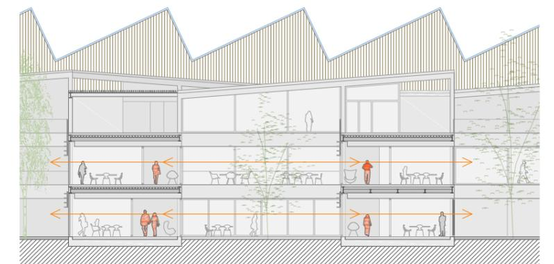
En sección transversal vemos cómo los trazados de las circulaciones además de atravesar los puntos de trabajo tratan de relacionarse entre ellas a través de los patios, cuya sección permite que se establezca esa conexión visual.
