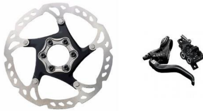
Figura 15.- Disco Shimano disco RT76 y sistema de frenos Agura MT5 de 4 pistones. Fuente: bike.shimano.com.
