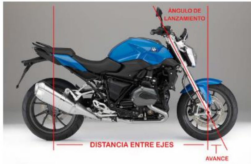
Ilustración 4 Esquema de los parámetros más significativos de la geometría de una motocicleta.
