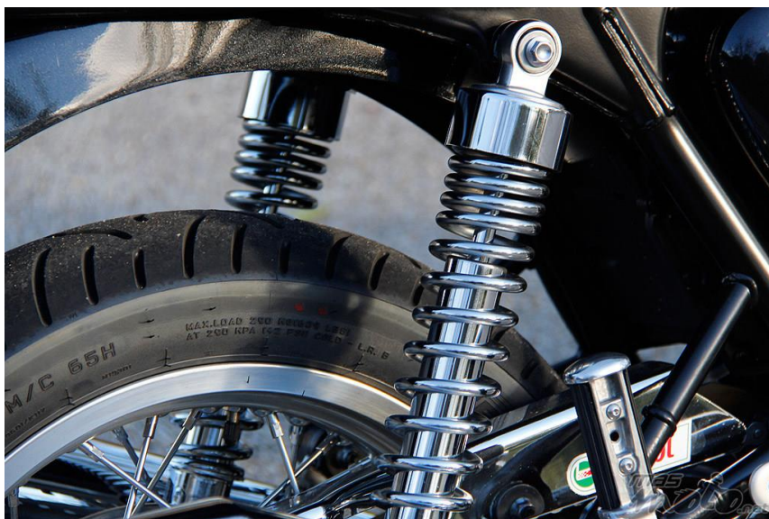
Ilustración 8 Ejemplo de basculante con parejas de amortiguadores (uno en cada brazo).
