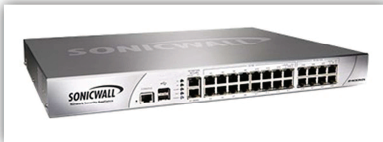
Ilustración 73. Cortafuegos SonicWALL NSA 2400 MX.
