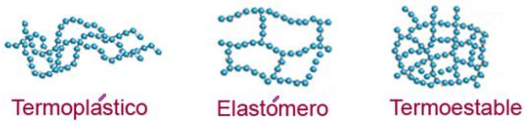
Figura I.8. Representación esquemática de la estructura molecular de los diferentes tipos de polímeros.
