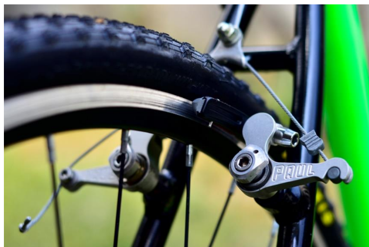
Figura 8: Ejemplo freno de cantilever
