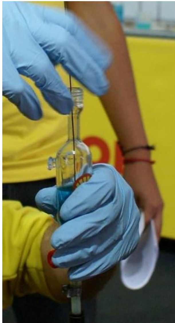
Figura 4: Medida del combustible tras una tanda
