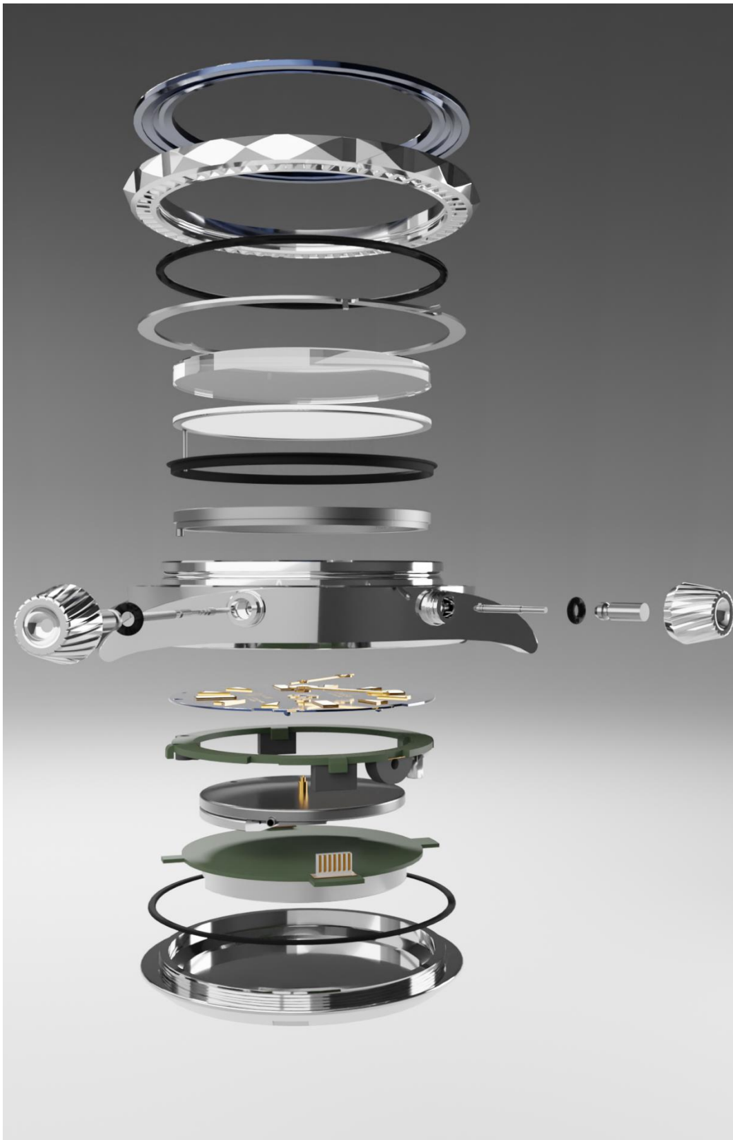
Ilustración 45: Posiciones de las piezas en el desmontaje del producto
