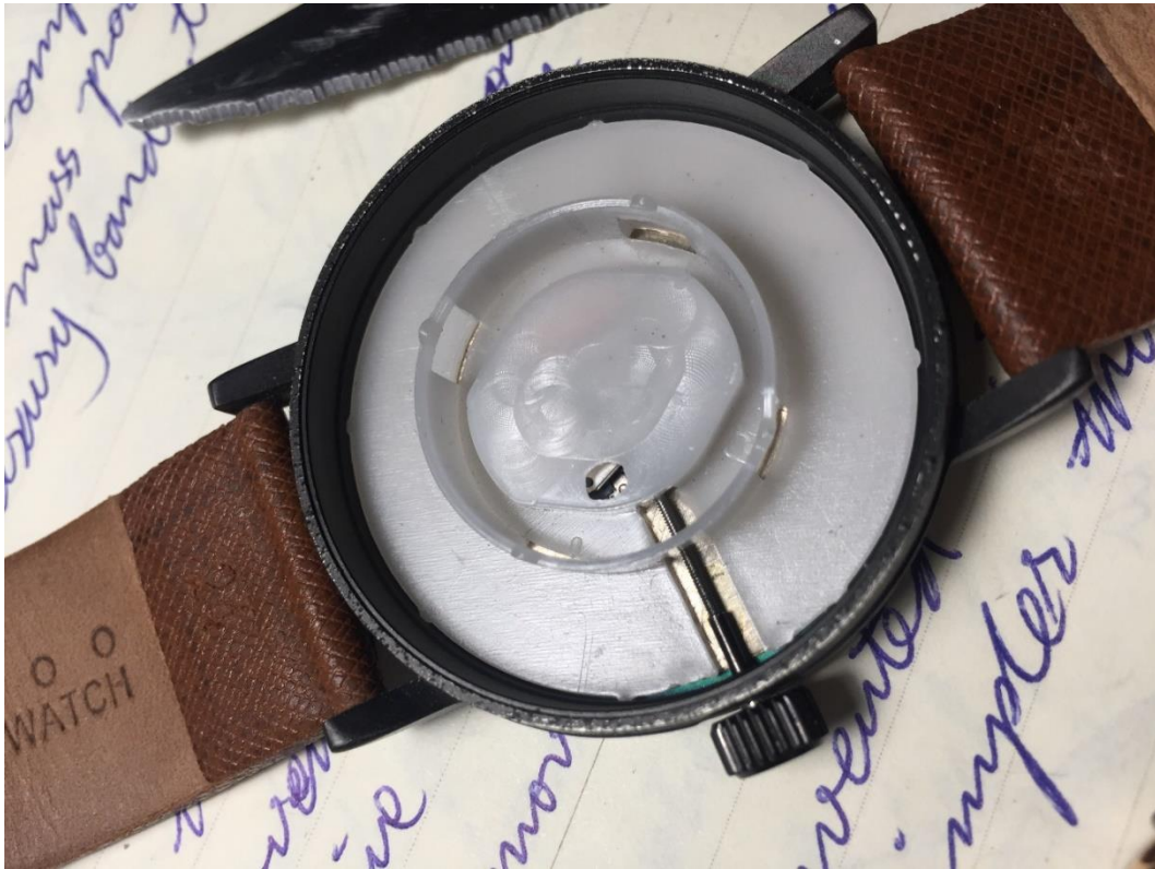
Imagen 50: Anillo de retención (pieza blanca) en un reloj de cuarzo (labor propia)
