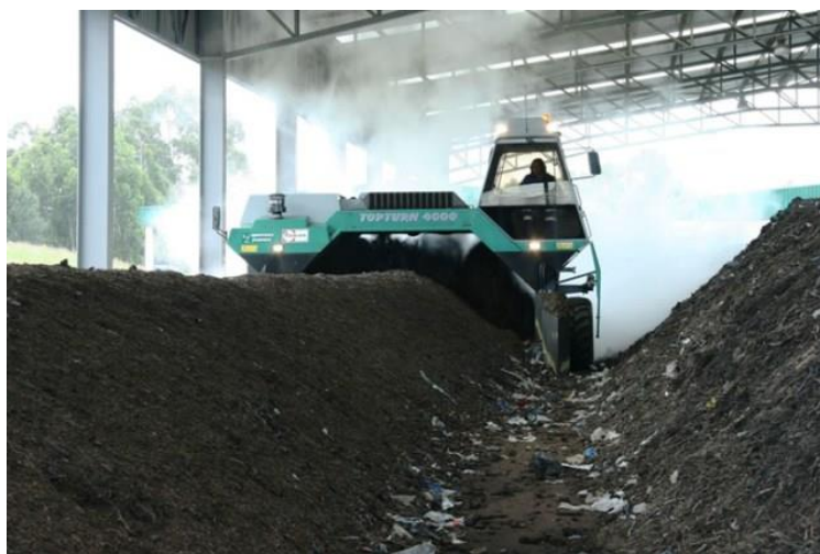
Ilustración 5: Máquina volteadora de compost
