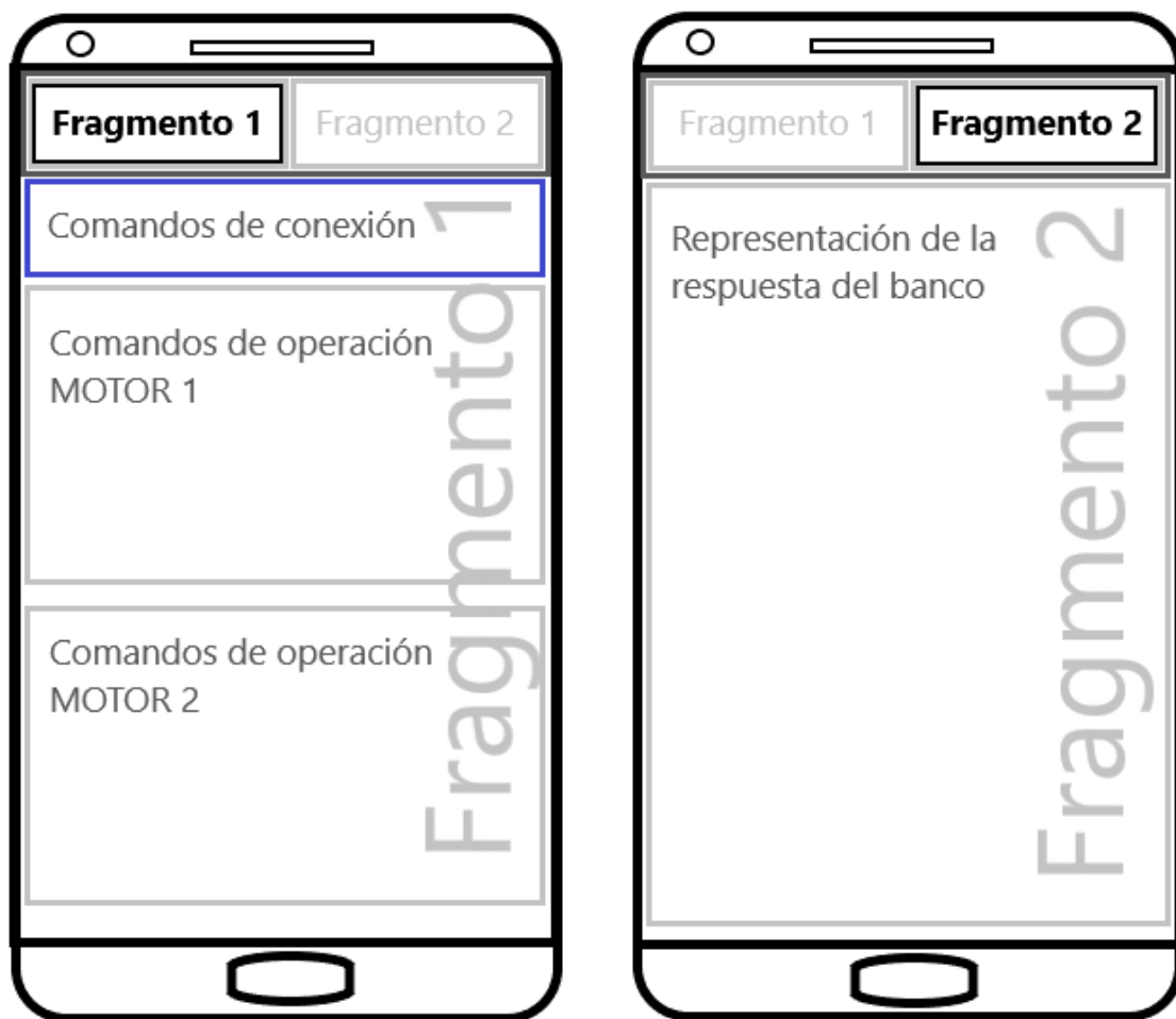
Ilustración 17. Imagen de la etapa de diseño de la aplicación. Fuente propia. En esta imagen se muestra una vista esquemática de ambos fragmentos, mostrando las funciones que se pretende implementar en cada área.
