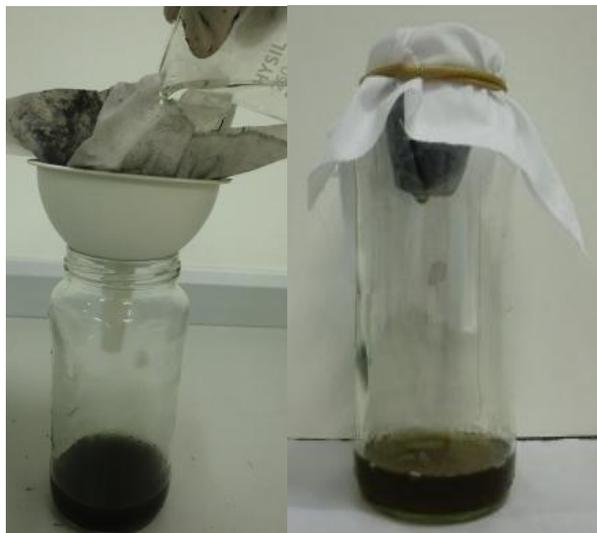
**Foto6.** La filtración de la solución mediante tela de algodón muy fina
