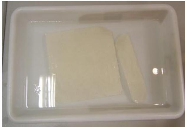
**Foto12.** Tratamiento de blanqueo mediante peróxido de hidrógeno sobre la tela de algodón
