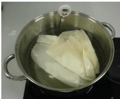
**Foto2.** Lavado de la tela de algodón con agua destilada neutral a una temperatura 70°C
