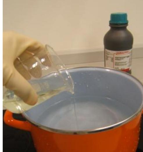
**Foto15.** Mezcla con  $\text{H}_2\text{O}$  e hipoclorito de sodio ( $\text{NaClO}$ ) al 5%
