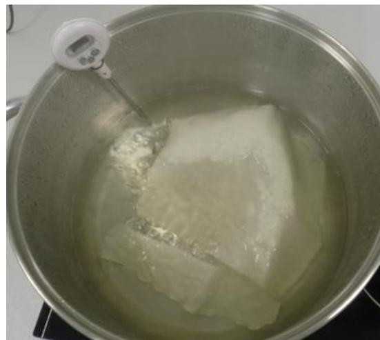
**Foto9.** Tratamiento de blanqueo mediante la solución realizada con ceniza de paja de arroz y agua destilada sobre la tela de algodón.
