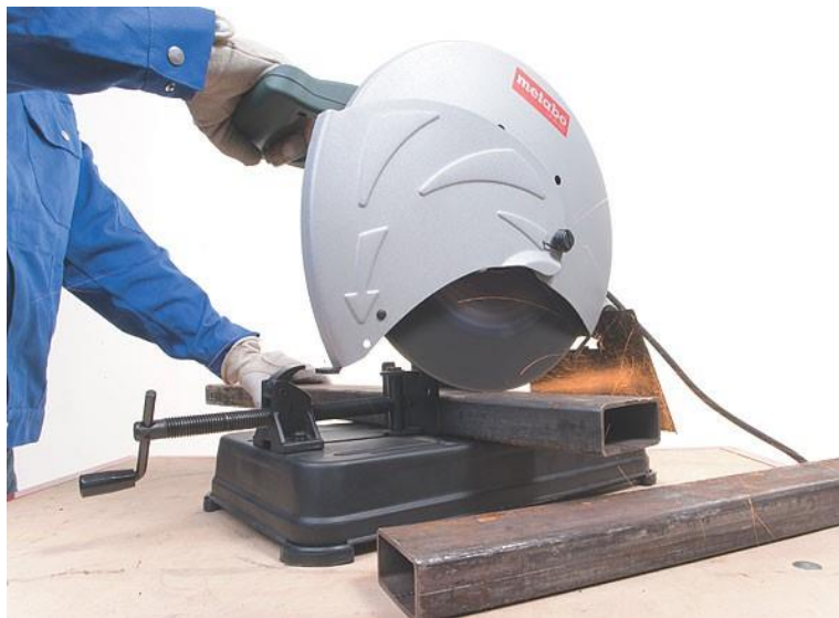
Fig 1.11 Sierra corte tubería acero
