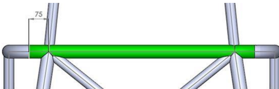
Dibujo 10 - Vista en planta de detalle del arco principal, cotas en mm
