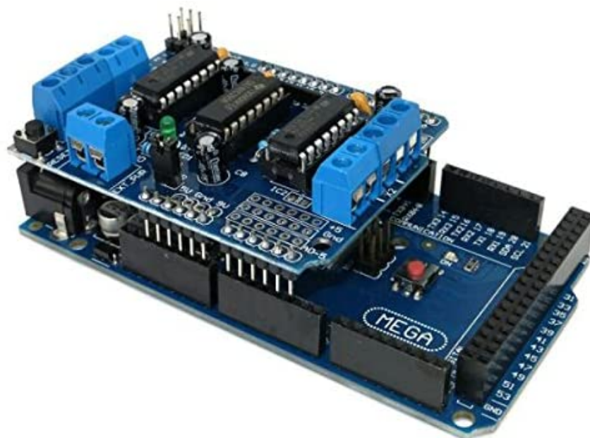
Figura 9. Conexión Arduino Mega 2560 con L293D Shield
