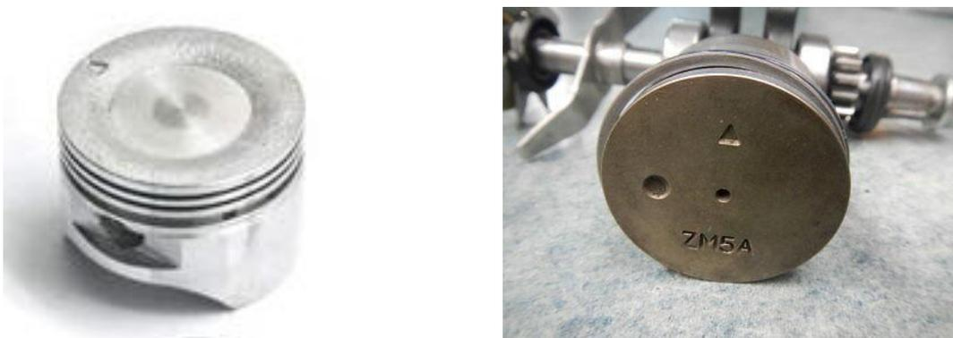
Figura 2.3.8: Pistones del motor Honda GX35 y Honda GX31 en las imágenes de la izquierda y derecha respectivamente. (Fuentes: <https://articulo.mercadolibre.cl/MLC-497964825-kit-piston-desmalezadora-honda-gx35-hht35-hht35s-JM?quantity=1> & <https://picclick.co.uk/Crankshaft-Piston-Crank-Shaft-Honda-Rototiller-Fq100-143327893105.html>)
