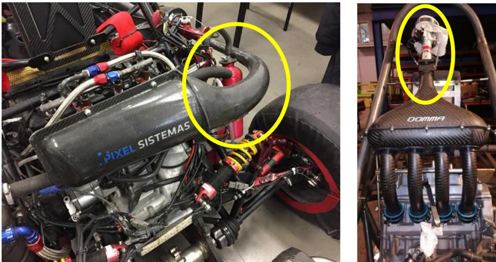
Figura 2.4.2: Conductos de entrada de sección creciente en admisiones de aire para vehículos de la competición Fórmula Student. [12](Fuentes: <http://imprimalia3d.com/noticias/2018/03/08/009805/tecnun-motorsport-reduce-semanas-horas-piezas-autom-vil-merced-impresi-n>)
