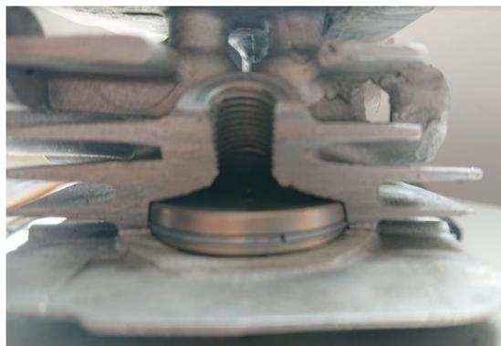
Figura 2.3.2: Cámara de combustión del motor Honda GX35.
