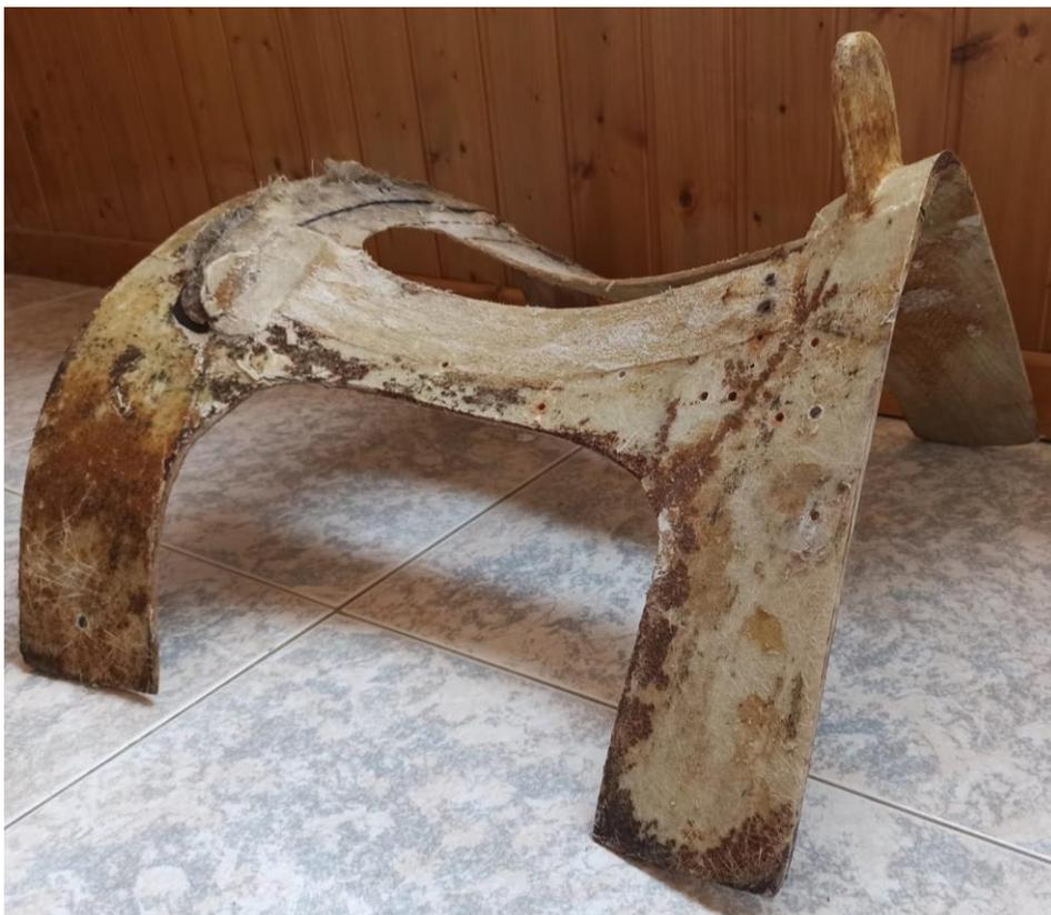
**Figura 3. 5.** Armazón de Fibra Fracturado 2
