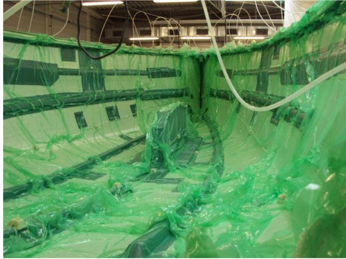
**Figura 1. 36.** Moldeo por Vacío
