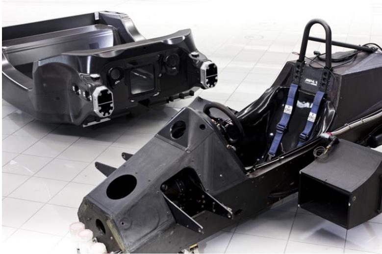
**Figura 1. 34.** Monocasco de Fibra de Carbono de MP4/1
