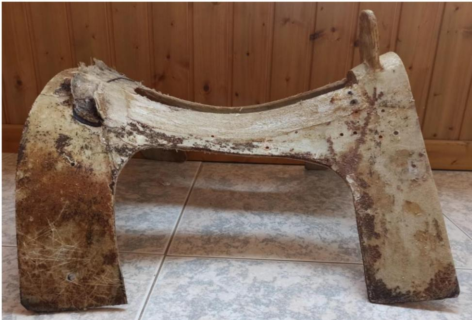
**Figura 3. 4.** Armazón de Fibra fracturado
