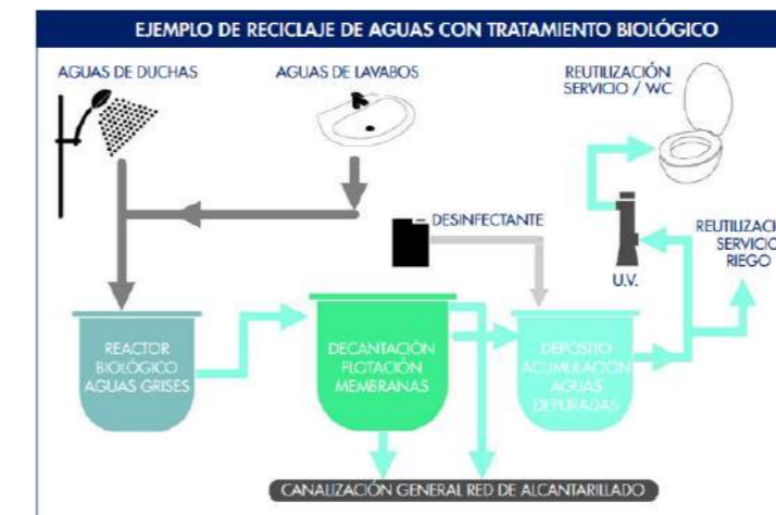
Fig. 26. Reciclaje con tratamiento biológico. Fuente: Guía técnica española de recomendaciones para el reciclaje de aguas grises en edificios.
