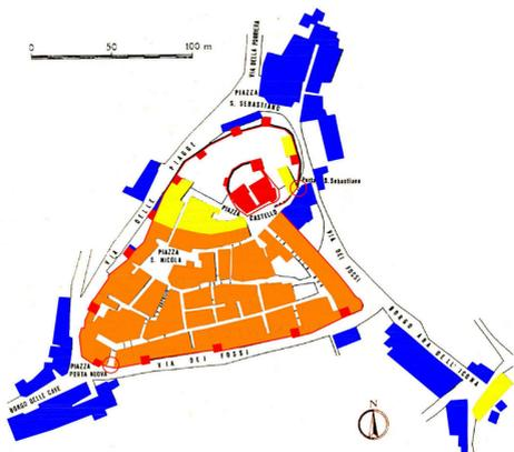
Fig. 5. Arnara, planimetria catastale: in colore rosso il castello, le mura con le torri e le porte d'accesso del borgo; in colore giallo la prima fase di espansione; in colore arancione la seconda fase di espansione; in colore blu le espansioni fuori dalle mura (elaborazione grafica A. Cattaneo, 2019 sulla base degli studi di S.A. Curuni, M. Salvatori, 1976).
