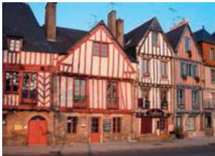
Ilustración 4. Casa de madera típica con muro entramado
