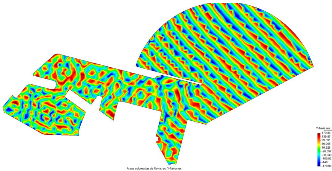
Figura A.III. 41. Diagrama de fases para la dirección S con periodo 8.143 seg. Fuente: Elaboración propia con uso del GID
