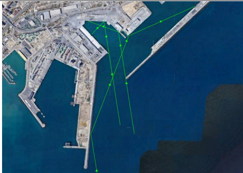
Figura IV.2. Incidencia del oleaje en el interior del puerto. Fuente: Google Earth Pro con modificación [Consulta:10 de junio de 2020]
