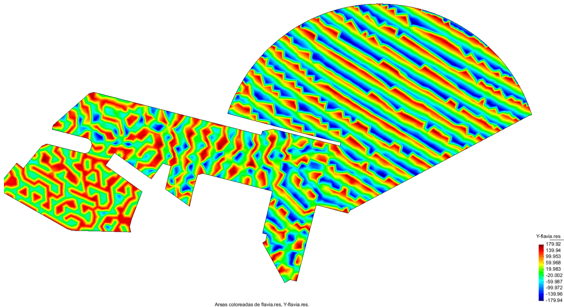
Figura A.III. 33. Diagrama de fases para la dirección SSE con periodo 7.941 seg. Fuente: Elaboración propia con uso del GID
