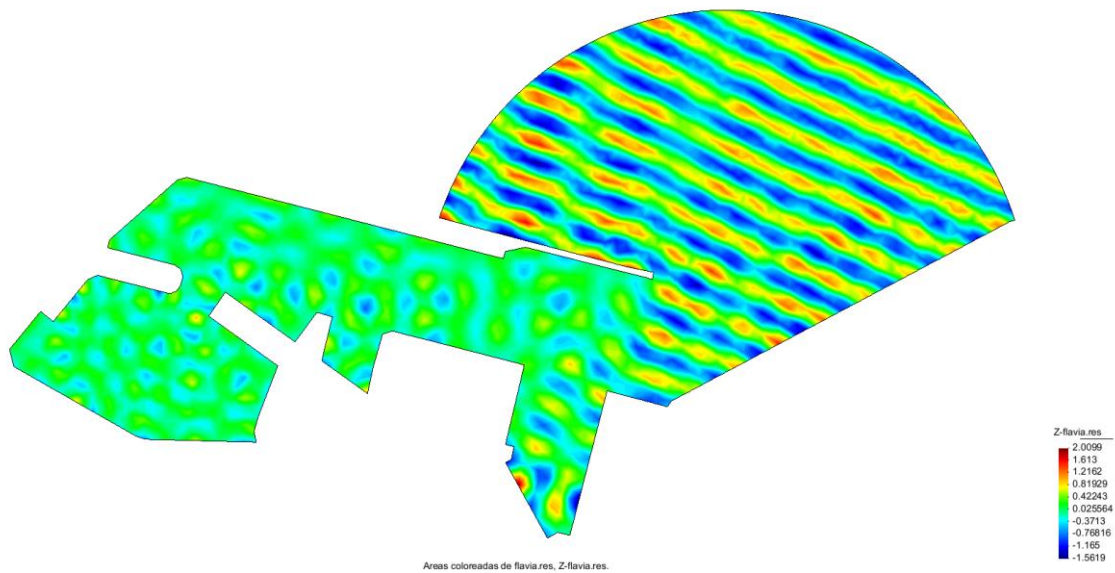
Figura A.III. 22. Coeficientes de agitación para la dirección SSE con periodo 9.929 seg. Fuente: Elaboración propia con uso del GID
