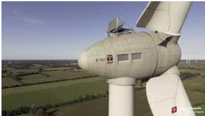
Figura 46. Aerogenerador E-101 (3,05 MW).
