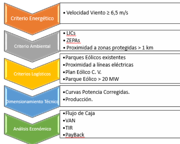
Figura 16. Metodología a seguir para explicar el cálculo de un aerogenerador.
