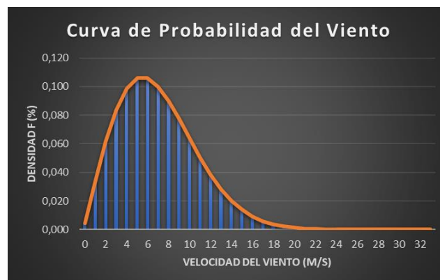
Figura 40. Curva de Probabilidad del viento.
