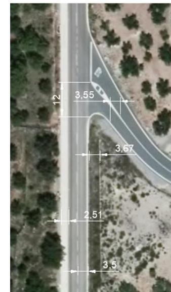
Figura 13 sección transversal de las carreteras
