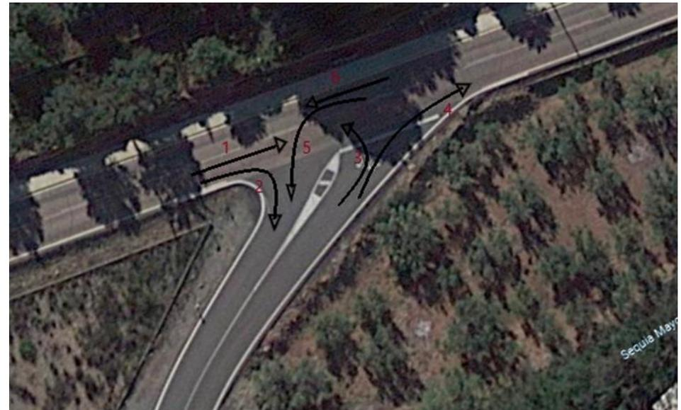
Figura 26 Movimientos posibles en la intersección
