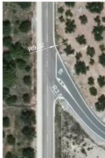
Figura 10 Radios de giro de la intersección
