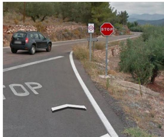
Figura 14 Señalización vertical, R2 "STOP"
