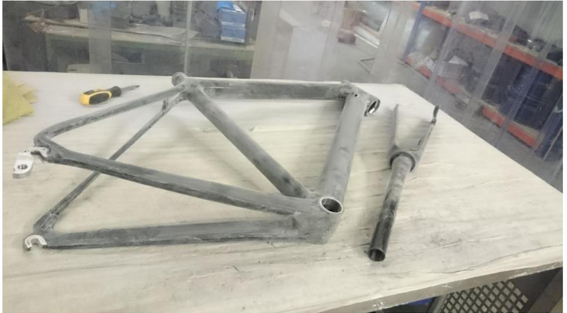
*Figura 19. Ejemplo de cuadro tras el proceso de lijado.*
