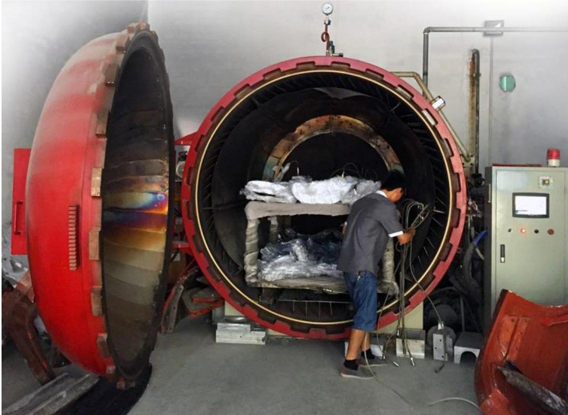
Figura 18. Horno autoclave.
