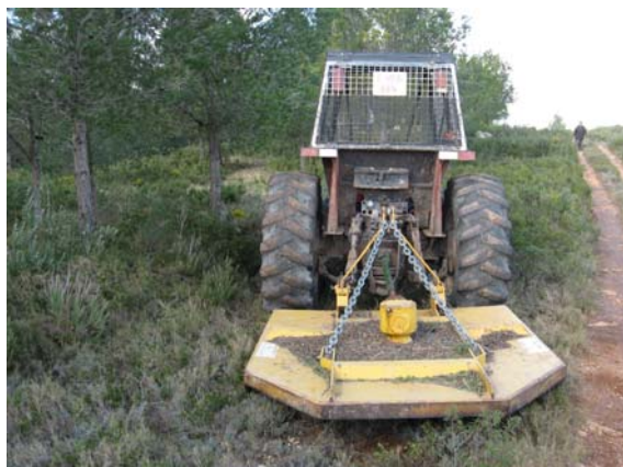
Fotos 9 y 10. Eliminación de residuos mediante desbrozadora de cadenas accionada por tractor
