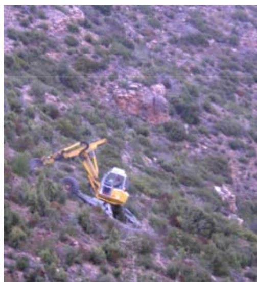
Fotos 1 e 2. Preparación del terreno mediante retroaraña
