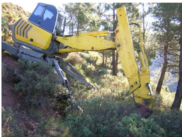
Fotos 1 e 2. Preparación del terreno mediante retroaraña
