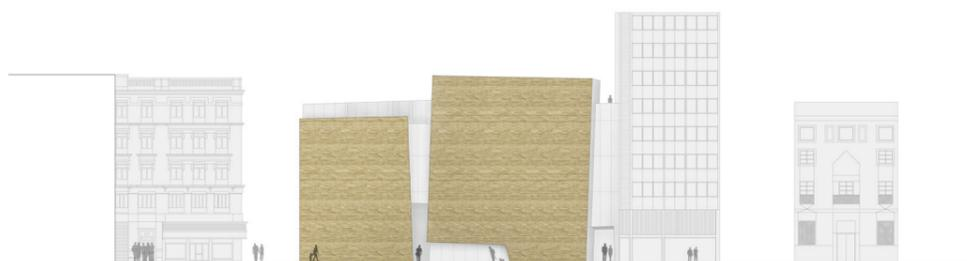
Para la capa exterior de fábrica de ladrillo se han utilizado ladrillos de diferentes espesores, para dar un juego visual a la fachada. De esta forma se han ido intercalando hiladas de 2,8 cm, 3,8 cm y 4,7 cm que son las medidas de distribución del fabricante, hasta conformar un módulo de 1 metro de altura, que se va repitiendo hasta la altura requerida para cada volumen.
