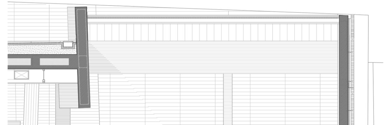
03\_ el forjado de planta baja posee un espesor de 60 cm, con nervios de 25 cm de espesor cada metro para absorber los vuelos que provocan las dobles alturas del sótano y transmitir las cargas de la carpintería del muro cortina a los apoyos.
