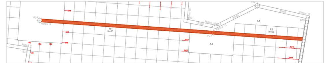
02\_ en la planta cuarta un zuncho de un metro de espesor que descansa en el pilar de 50 cm de diámetro y en el muro estructural soporta el peso de los lucernarios, ayudado por el muro perimetral opuesto.
