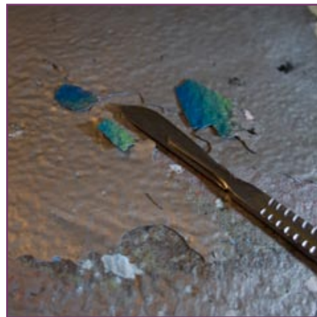
Fig. 46. Detalle limpieza reverso probeta Neptune's Cum
