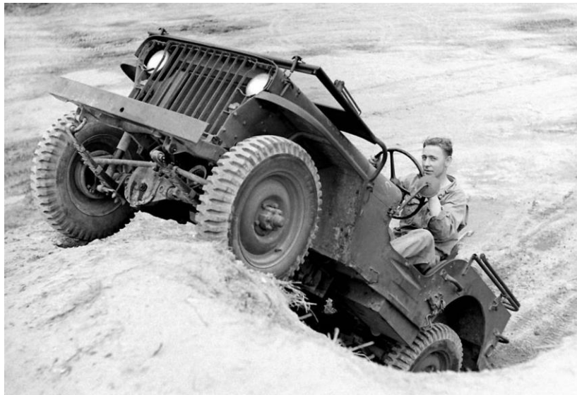
Figura 6: [2-6] El Willys MB que heredaba las entradas del Bantam y el capó del Ford (Ref. 5)
