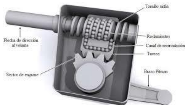
Figura 66: [5-51] Sistema de dirección a base de bolas circulares (Ref. 15)
