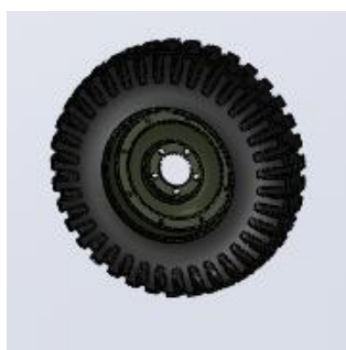
Figura 18: [5-5] Modelo de una rueda del Willys MB en SolidWorks
