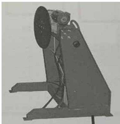
Imagen 19: Mesa de rotación con motor 24Vdc
