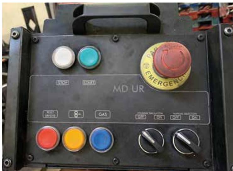
Imagen 3: Botonera actual para el control de la máquina
