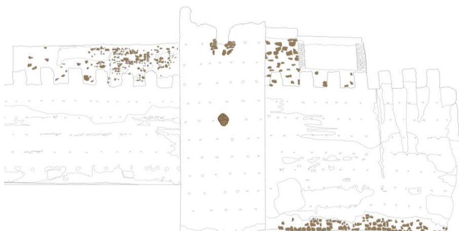
Imagen 99. Alzado Norte con mampostería en el lienzo 3, torre D y lienzo 4. Escala 1/200. Fuente: Autora.
