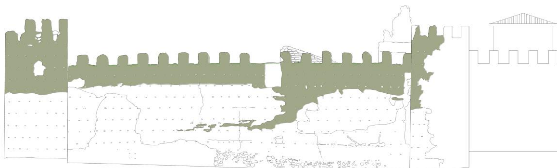
Imagen 102. Alzado Norte con líquenes en torre A y lienzo 1. Escala 1/200. Fuente: Autora.
