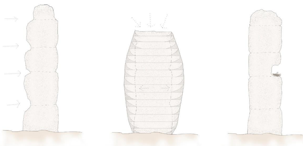
Imagen 49. Proceso de degradación en masa y superficie de un muro de tapia. Fuente: redibujado por la autora sobre la base de Gómez-Patrocínio, 2018:173.
