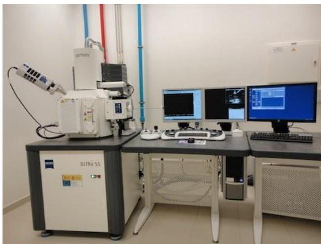
**Figura 4.12.** Microscopio electrónico de barrido de emisión de campo (FESEM) *Ultra 55* de *Zeiss*® del Servicio de Microscopía de la UPV.
