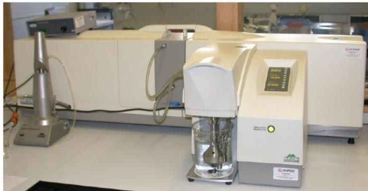
**Figura 4.1.** Difractómetro láser *Mastersizer 2000* de *Malvern Instruments*®.
