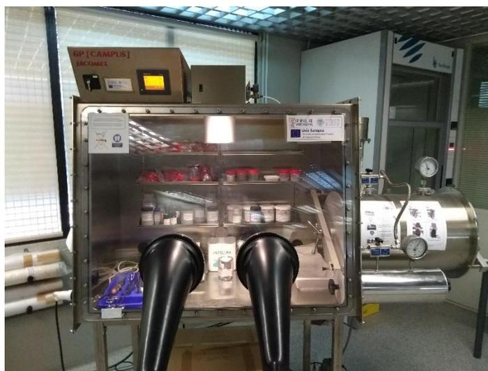
**Figura 4.4.** Cámara de guantes GP [Campus] de *Jacomex*® donde se almacenan los polvos metálicos en atmósfera controlada.
