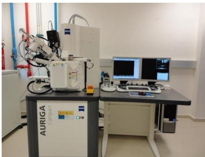
**Figura 4.13. Microscopio electrónico de barrido con emisión de campo (FESEM) modelo *AURIGA Compact* marca *Zeiss*, utilizado para el estudio cristalográfico.**
