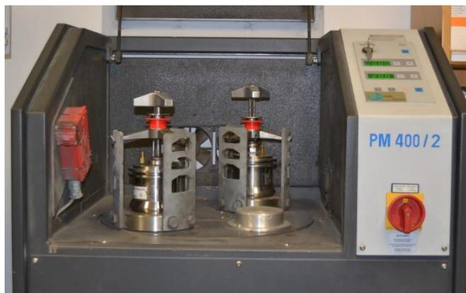
**Figura 4.5.** Molino planetario modelo *PM 400/2* marca *Retsch*® empleado para la mezcla mecánica de los polvos.
