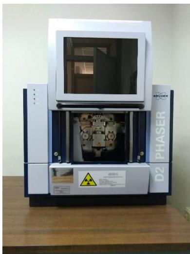
**Figura 4.11.** Equipo de difracción de rayos *D2Phaser* de *Bruker*®.
