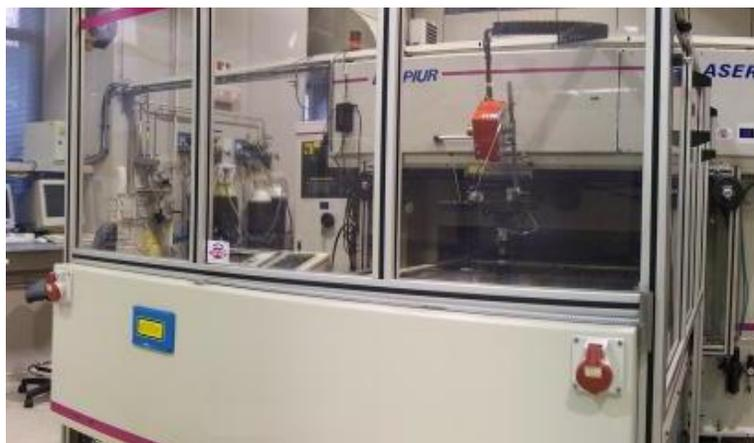
Figura 4.9. Equipamiento láser de estado sólido Nd:YAG modelo *DY022* de *Rofin Sinar*®, utilizado para la modificación superficial mediante fusión por láser (LSR).
