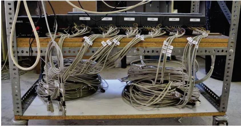
Fotografía IV.5: Equipo de adquisición modular FieldPoint de NI
