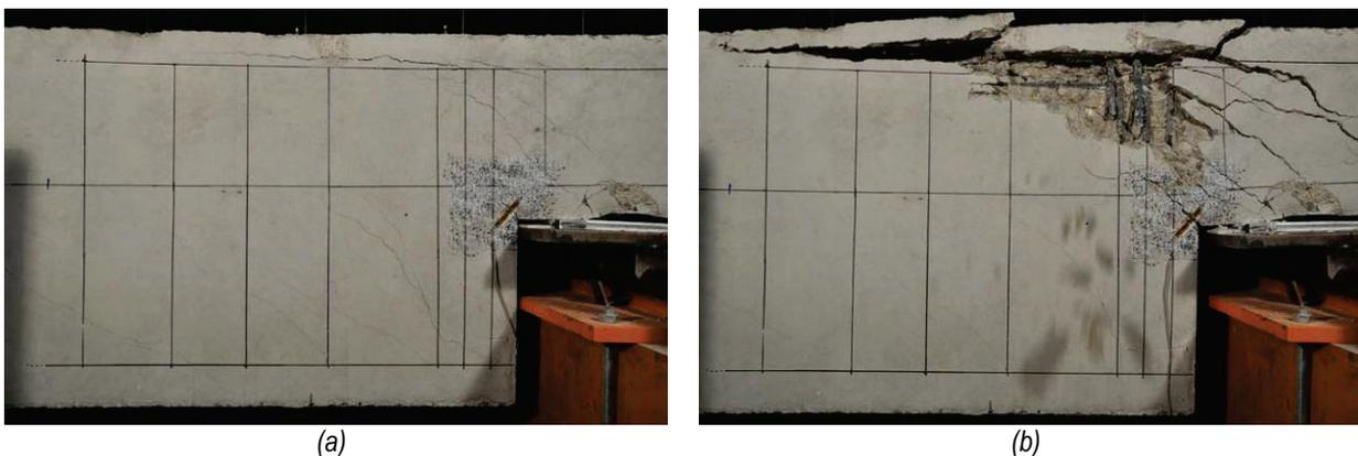
Fotografía VI.1: Rotura de pieza. E014A1 (a) Instante previo a rotura - (b) Instante posterior a rotura
