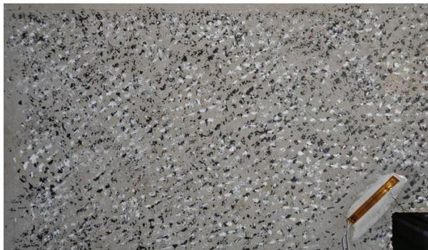
DETALLE DE LA ZONA DE FISURACIÓN A LA CARGA MÁXIMA
