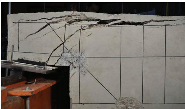
LEVANTAMIENTO DEL LEVANTAM. DE RECUBRIMIENTO TRAS ROTURA
