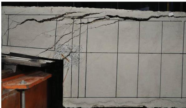
DETALLE DE ROTURA. ELEVADA DEFORMACIÓN ARMADURA HOR.
