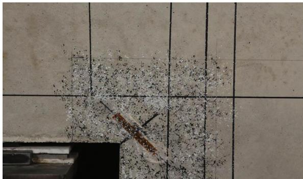
DETALLE DE FISURACIÓN DE LA PIEZA A LA CARGA MÁXIMA
