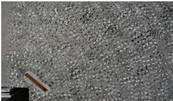
DETALLE DE FISURACIÓN A LA CARGA MÁXIMA
