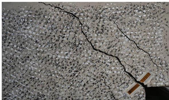
DETALLE DE LA ZONA DE FISURACIÓN TRAS LA ROTURA
