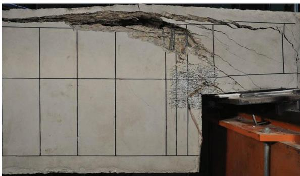
DETALLE DEL APOYO TRAS RETIRAR ELEMENTOS DESPRENDIDOS
