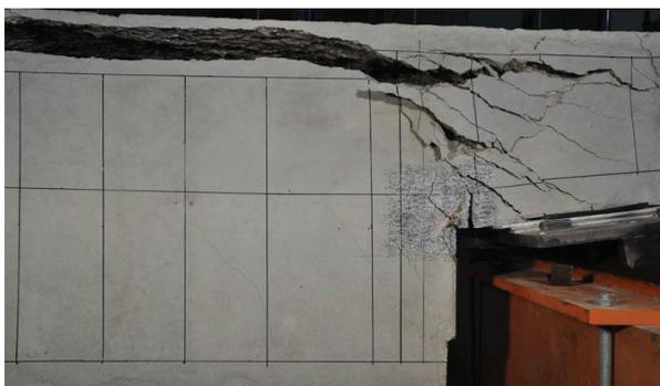
DETALLE DE FISURACIÓN BAJO EL APOYO
