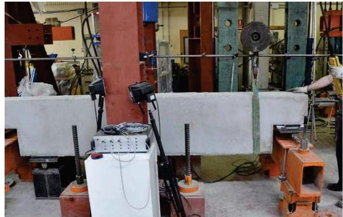
Fotografía IV.8: Montaje de probeta en pórtico de ensayo
