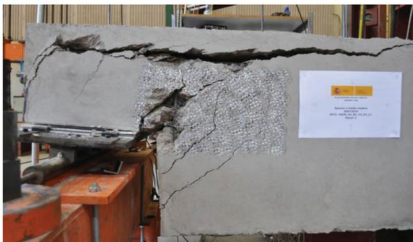
VISTA GENERAL DE LA PIEZA TRAS LA ROTURA. FISURAS FLEXIÓN
