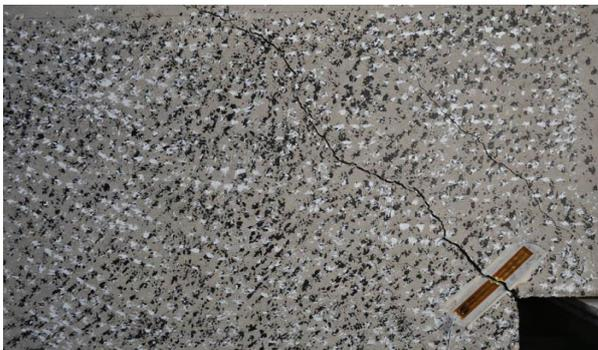
DETALLE DE FISURACIÓN A LA CARGA MÁXIMA
