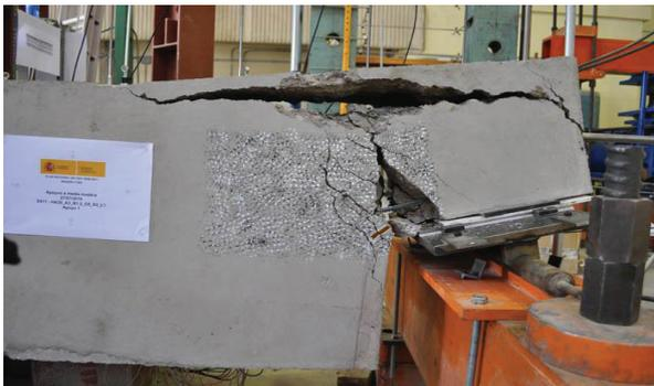
DETALLE DE ARMADURAS HORIZONTALES ROTAS
