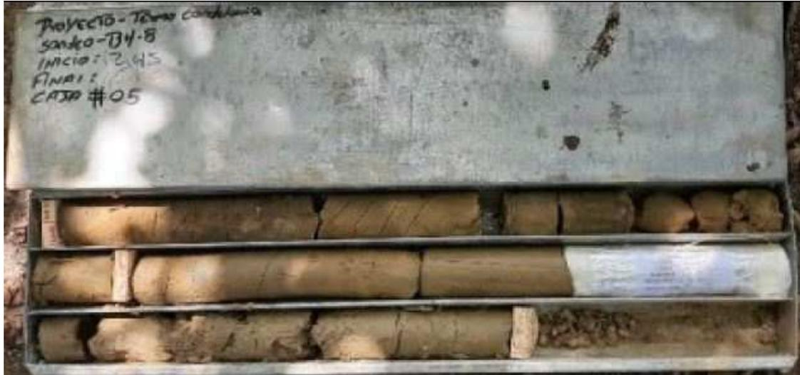
Figura 22. Aspecto general de la Unidad Geotécnica UG-4.
