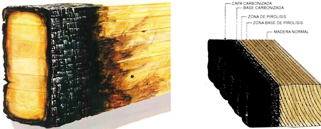
Figura 34. Capa carbonizada en una viga de madera
