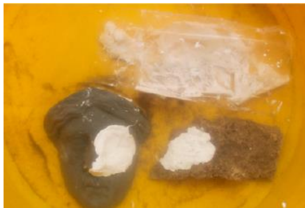
Figura 11. Elastómero aplicado. Sustancia C. Probeta 8
