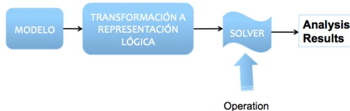
Figura 2.6 Proceso para analizar una Línea de Productos Software [4]
