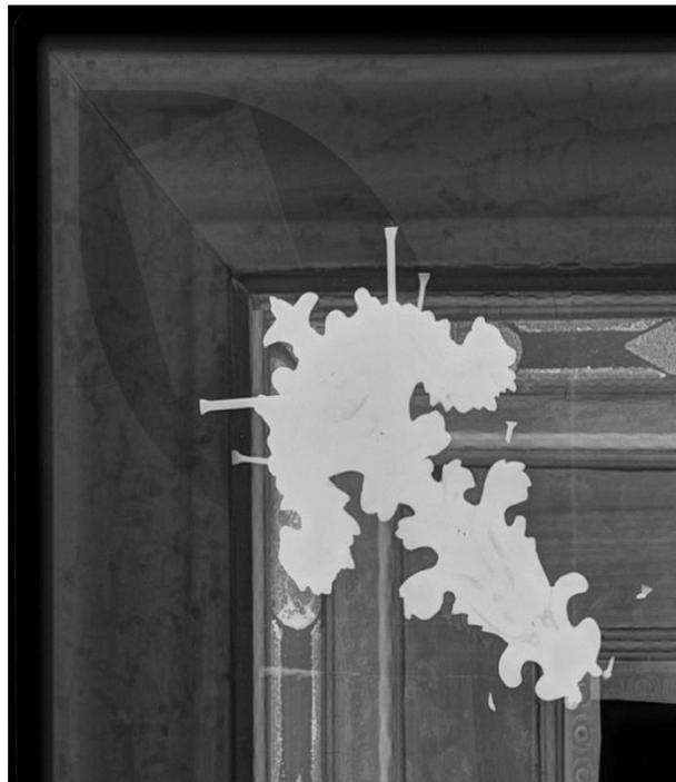
Figura 10. Detalle del registro fotográfico de rayos X del marco donde se pueden apreciar las galerías de los xilófagos.
