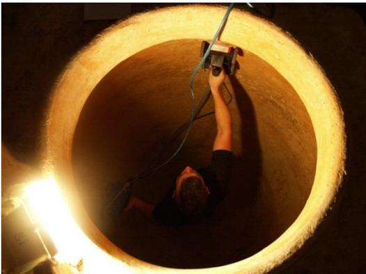
Figura 8. Empleo del georradar en la pared de la vasija.
