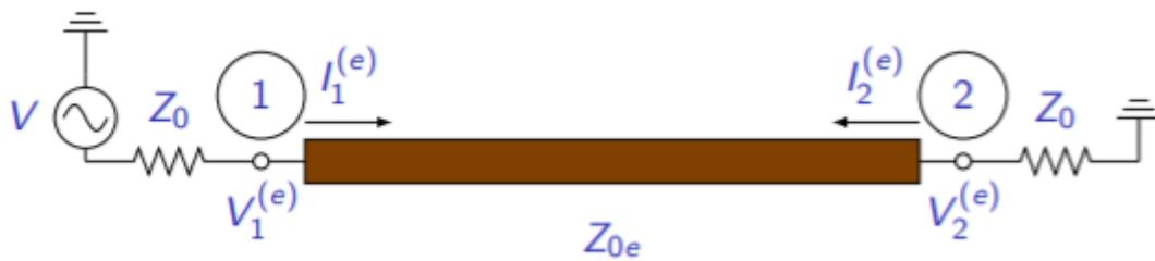
Figura 13. Circuito equivalente para el modo par del puerto 1 y 2.
