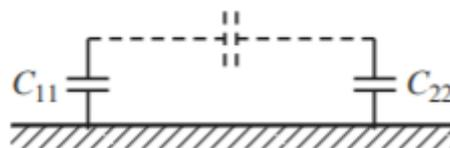
Figura 8. Circuito equivalente para el modo de excitación par.
