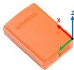
Figura 27. Sensor inercial y sistema de referencia local [25]
