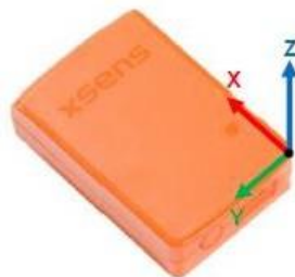
Figura 12. Sistema de coordenadas predeterminado de un MTw [25]
