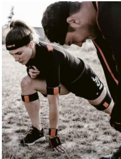
Figura A1. 1 Colocación de los sensores Xsens en el brazo [25]
