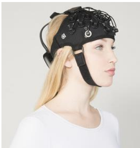
FIGURA 6 Dispositivo Brite de la empresa Artinis basado en la tecnología NIRS para el monitoreo de la actividad cerebral. Dispone de 23 canales que cubren el córtex frontal. Permite medir los cambios en la concentración de oxihemoglobina, desoxihemoglobina y la hemoglobina total. 8
