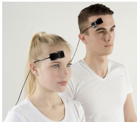
FIGURA 7 Dispositivo Portalite de la empresa Artinis basado en la tecnología NIRS para el monitoreo de la actividad cerebral. Permite medir la saturación de oxígeno local, siendo un dispositivo totalmente portátil para uso en actividades diarias. 9
