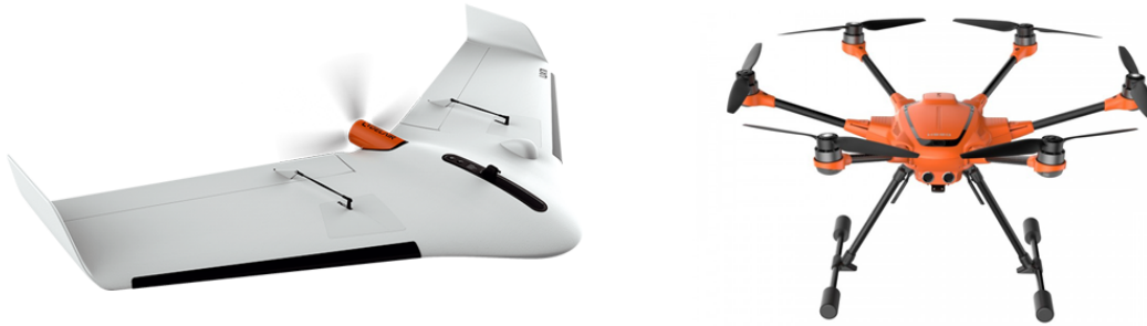
Figura 1.1: Ejemplos de UAV: de ala fija, modelo Delair UX11 (izq); y de ala rotatoria, modelo Yuneec H520 (der).
