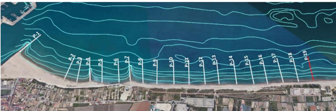
Ilustración 17. Perfiles de cálculo de volumen de arena necesario. Fuente: Elaboración propia.
