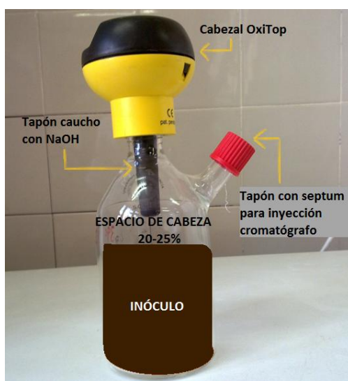
Figura 8. Esquema montaje experimental de la botella en el ensayo de la AME.
