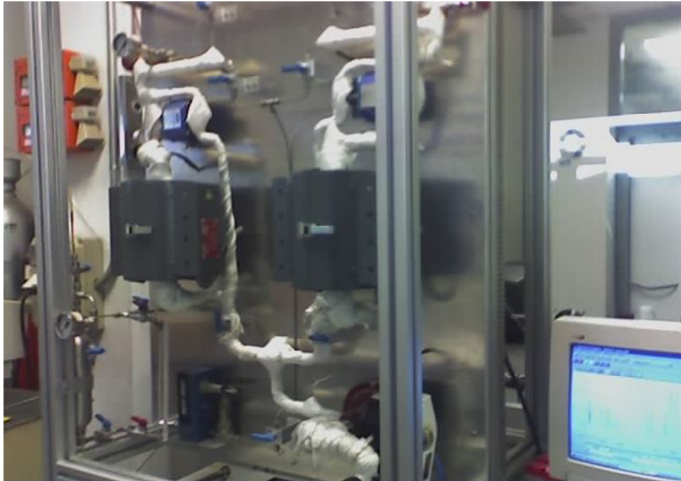
Figura 6. Foto del reactor empleado para el reformado de bioetanol. Reactor RIR 2(ITQ)
