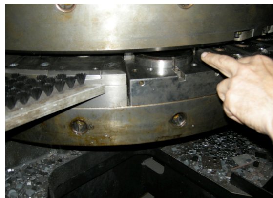
Fig. 27: extracción de matriz hembra
