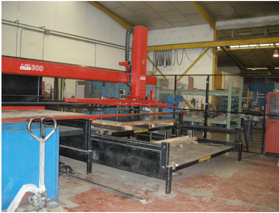
Fig. 24: cargador de la punzonadora
