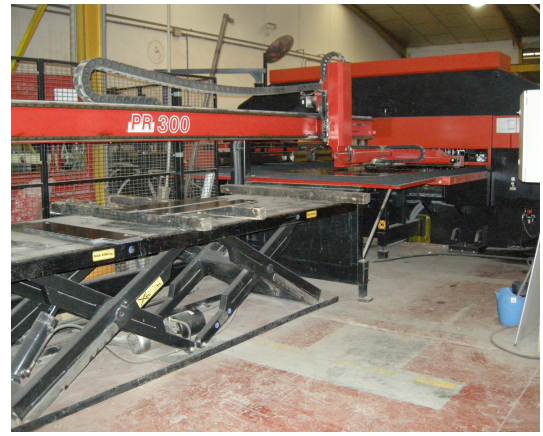
Fig. 25: salida de piezas ya punzonadas
