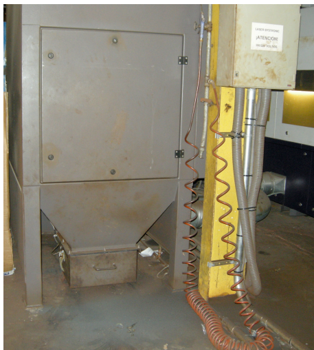
Fig. 32: bandeja de polvo residual
