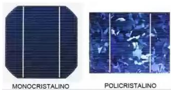
Figura 2. Células fotovoltaicas de silicio cristalino. Fuente: solar-energia.net
